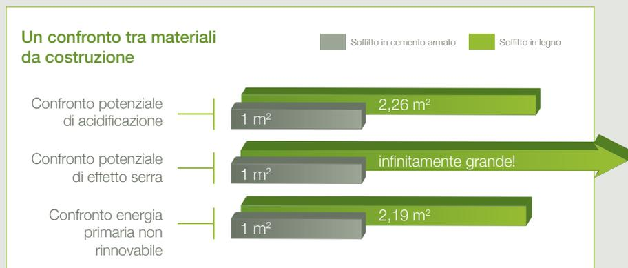
La produzione di un soffitto in legno della superficie di 2,26 m<sup>2</sup> provoca quasi lo stesso valore di acidificazione causato dalla produzione di un soffitto in cemento armato della superficie di un 1 m<sup>2</sup>. La stessa relazione si ha in considerazione dell'energia primaria non rinnovabile. Il legno non contribuisce all'effetto serra, e quindi anche in base a questo criterio ecologico è in vantaggio rispetto al cemento armato.
